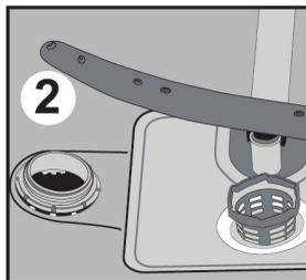
inférieur et retirez le couvercle du compartiment à sel en le tournant dans le sens contraire des aiguilles d'une montre. **1** **2** Versez le sel dans le compartiment au moyen de l'entonnoir. Attention de ne pas mettre de sel à côté, sinon, l'enlever aussitôt. **3** A la première utilisation, remplissez le compartiment avec 1 kg de sel et remplissez d'eau **4** à ras bord; revissez le couvercle. Remplissez le compartiment à sel (environ 1 kg) tous les 20 à 30 lavages.
