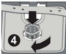
Tirez et retirez le filtre métal ou plastique. **3** Séparez ensuite le filtre à déchets et le microfiltre. **2** Rincez-le abondamment à l'eau courante. Réinstallez le filtre à déchet dans le microfiltre en faisant attention de bien faire correspondre les repères. Fixez le microfiltre sous le filtre métal ou plastique et tournez-le dans le sens de la flèche ; l'ensemble est verrouillé quand on peut voir la flèche sur le microfiltre. **4**
